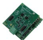
Pasarelas de aerotermia
