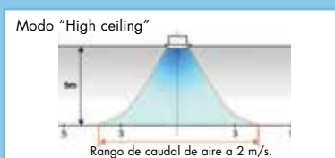
Modo "High Ceiling" que permite la instalación en techos de hasta 5m.
