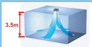
Modo "High ceiling". Permite su instalación en techos de altura hasta 3,5 m
